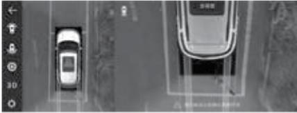
Передняя или задняя камера отображают обстановку вокруг автомобиля во время движения. Изображение формирует вид сверху, спереди или сзади автомобиля, приближающегося к препятствиям. Вспомогательные парковочные сенсоры, расположенные на переднем и заднем бамперах, помогают контролировать и объезжать препятствия.
