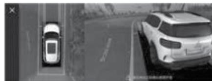
При включении сигнала поворота на скорости менее 20 км/ч, активируется 3D изображение автомобиля с обзором окружающей среды вокруг автомобиля и улучшенным качеством изображения в зоне поворота.
