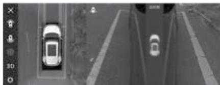
Режим обзора колес (передние и задние) позволяет более интуитивно видеть положение автомобиля и предметов окружающей среды (бордюр, дренажная канава, линия грунта и т.д.), что помогает при парковке.
