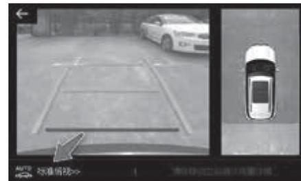
Чтобы активировать камеру, расположенную рядом с фонарями освещения номерного знака, включите передачу заднего хода и не превышайте скорость 10 км/ч.
