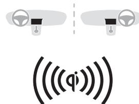
Оно позволяет выполнять беспроводную зарядку портативного устройства, например, смартфона, используя принцип магнитной индукции в соответствии со стандартом Qi 1.1.
