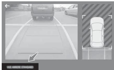
При включении передачи заднего хода система активируется автоматически.
