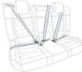
Заднее сиденье оборудовано ремнями безопасности с 3-точечными инерционными натяжителями. Ремни безопасности для боковых мест оснащены устройствами предварительного натяжения и ограничителями усилия.
