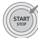
Внесите электронный ключ в салон и нажмите кнопку **START/STOP**, **не нажимая на педали** — зажигание включится без запуска двигателя (включение панели приборов и вспомогательных устройств, например, аудиосистема и освещение).
