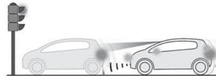
Эта система (т. н. «автоматическое экстренное торможение») срабатывает после включения уведомления, если водитель не реагирует
