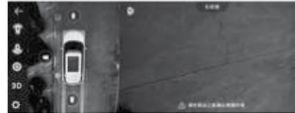
Вид слева / права позволяет вам более интуитивно видеть автомобиль и окружающую среду с обеих сторон (например, тротуары, низкие стены, припаркованные поблизости транспортные средства и т.д.)
