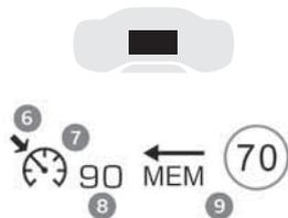
6. Состояние ограничителя скорости: включен (желтый)/приостановлен (серый)
