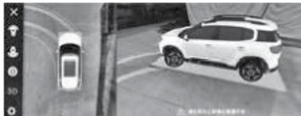
3D-просмотр предназначен для отображения 3D-модели автомобиля с окружающей средой и позволяет видеть местоположение автомобиля и обстановку вокруг, так же менять угол обзора.
