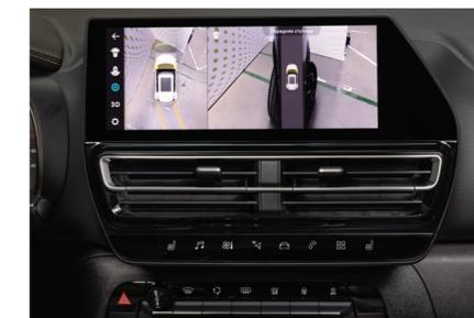
Обзор передних и задних зон колесных арок. Благодаря камерам, расположенным под боковыми зеркалами, недоступные обзору зоны колесных арок, становятся видимыми, что упрощает маневрирование при парковке и заезде в гараж.
